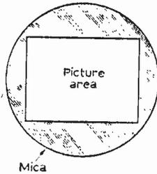
Fig. 5: Mica spacer.
