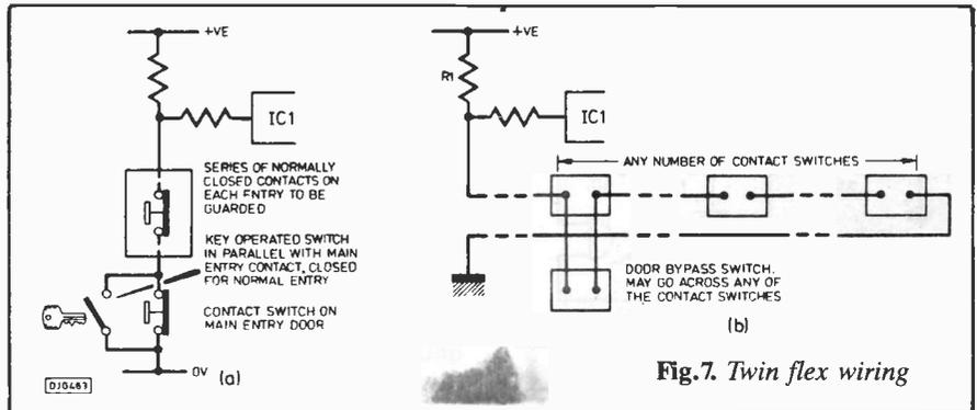
Fig.7. Twin flex wiring
