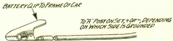
**HOW TO TAP THE MOTOR CAR BATTERY**
