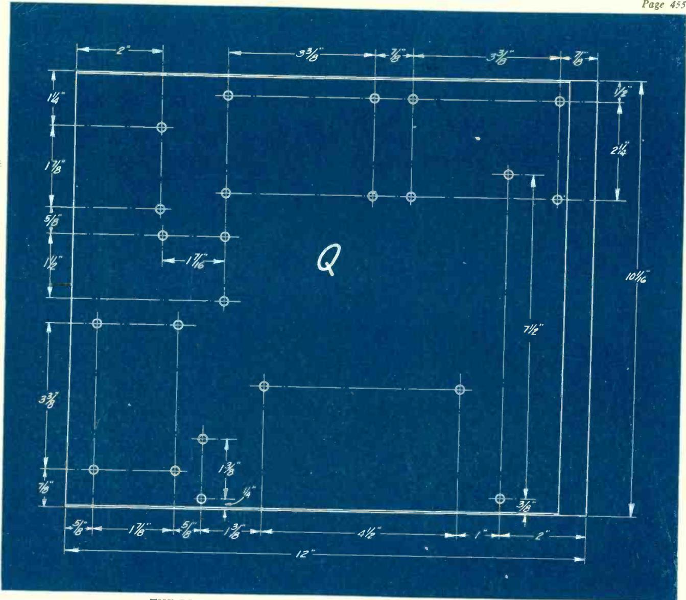
**THE DRILLING PLAN FOR THE BOTTOM HALF OF THE CASE Q**
