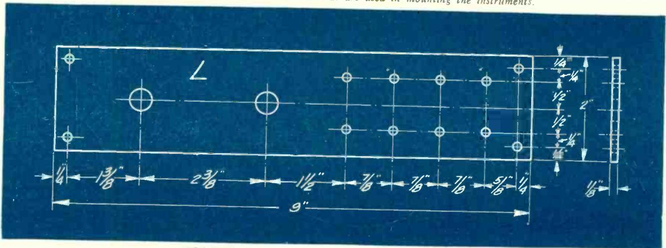
**THE DRILLING PLAN FOR THE SMALL PANEL L**
