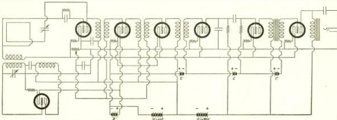
A SENSITIVE SEVEN-TUBE SUPERHETERODYNE CIRCUIT
