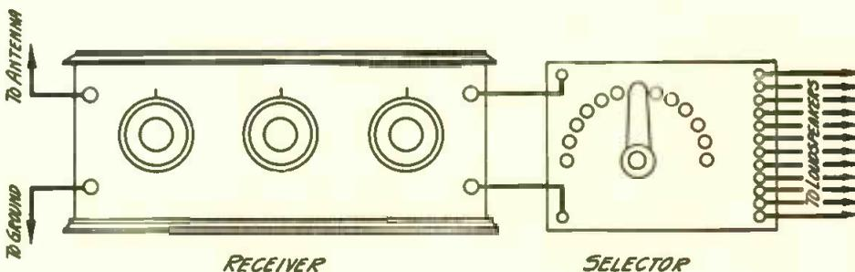
**THE HOOK UP FOR THE LOUDSPEAKER SELECTOR**
