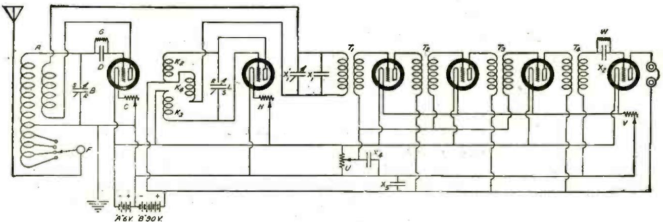
**A SUPER-HETERODYNE CIRCUIT FOR AIR-CORE INTERMEDIATE-WAVE TRANSFORMERS**
