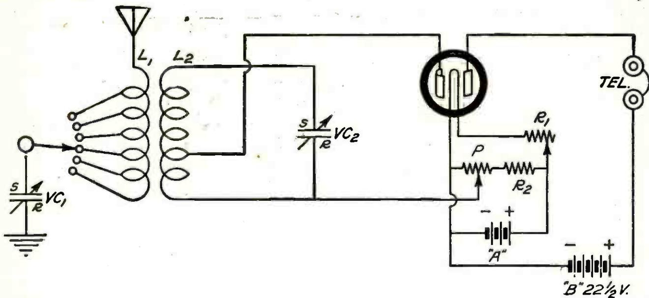
**NON-REGENERATIVE CIRCUIT FOR THE SODION TUBE**
