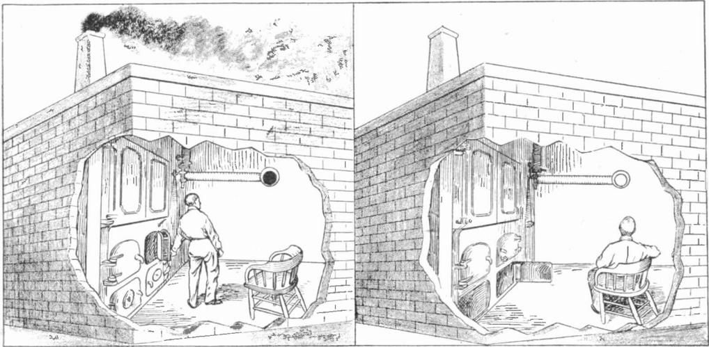
A GLANCE AT THE GROUND GLASS INDICATOR SHOWS WHETHER STACK IS SMOKING OR NOT
