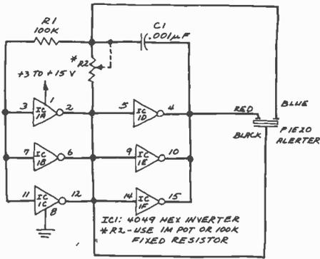
Fig. 4. An IC alerter driver circuit.
