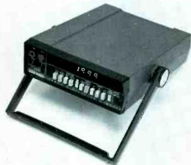
The Fluke 8000A 3½ digit multimeter
