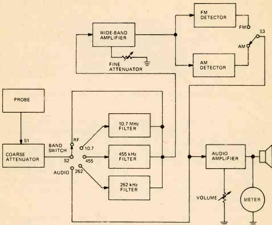
FIGURE 2. BLOCK DIAGRAM OF THE MODEL 231 SIGNAL TRACER.
