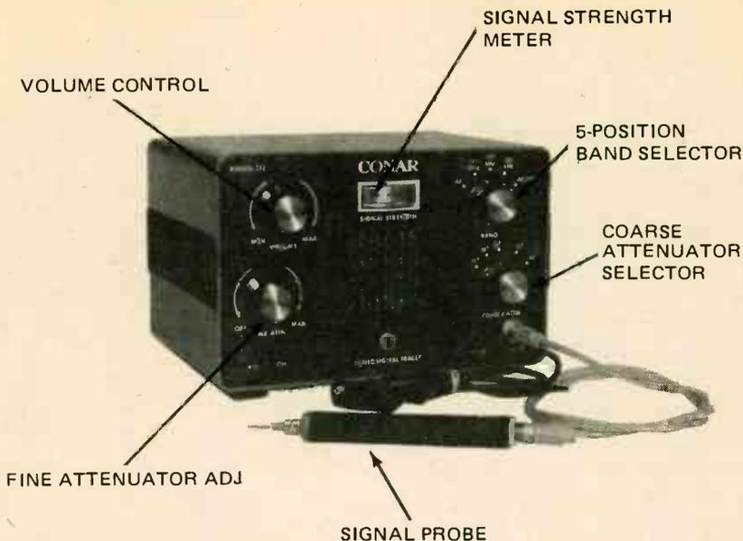
**FIGURE 3. FRONT PANEL OPERATING CONTROL LAYOUT OF THE MODEL 231 SIGNAL TRACER.**
