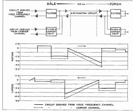
Fig. 12—Level Diagram.
