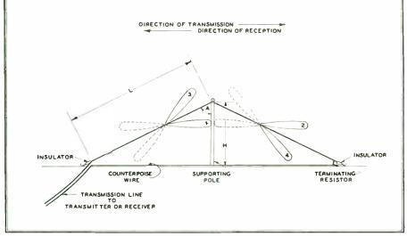
FIG. 13. THE HALF-RHOMBIC IS PREFERRED WHERE AVAILABLE SPACE IS LIMITED
