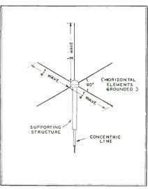
FIG. 3. THE GROUND-PLANE ANTENNA
