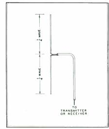
FIG. 1. SIMPLE VERTICAL HALF-WAVE DI-POLE
