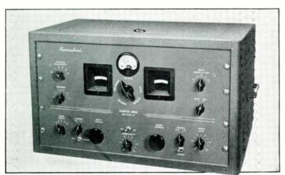
FIG. 2. LATEST MODEL OF THE HAMMERLUND SUPER-PRO SERIES
