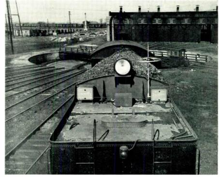
FIG. 10. THE CARTWHEEL GROUND-PLANE ANTENNA, AND THE WATERTIGHT ENCLO-SURES FOR THE TRANSMITTER AND RECEIVER, MOUNTED ON A LOCOMOTIVE
