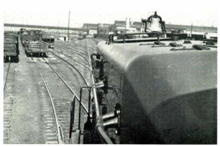
FIG. 12. THE 11-IN. FIRECRACKER ANTENNA CAN BE SEEN AT THE LEFT OF THE BELL
