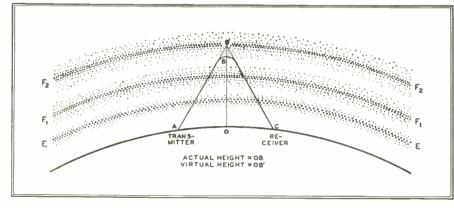
FIG. 3. TYPICAL PATH OF A WAVE RETURNED TO EARTH FROM THE F2 LAYER
