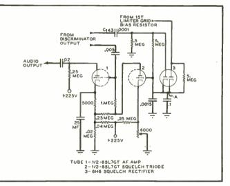
FIG. 11. CIRCUIT OF THE SQUELCH SYSTEM OF THE RECEIVER
