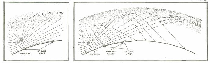
FIG. 6. LEFT: AM BROADCAST TRANSMISSION DURING DAYLIGHT HOURS IS BY MEANS OF THE GROUND WAVE. SKYWARD TRANSMIS-SION IS ABSORBED IN REGION BELOW E LAYER. RIGHT: AT NIGHT, SKYWAVES, RETURNED TO EARTH, GIVE LONG-DISTANCE COVERAGE, BUT CAUSE FADING IN THE OUTER PORTION OF THE AREA REACHED BY THE GROUND WAVE
