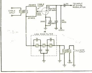
FIG. 9. AUDIO CIRCUIT OF THE FM CARRIER TRANSMITTER
