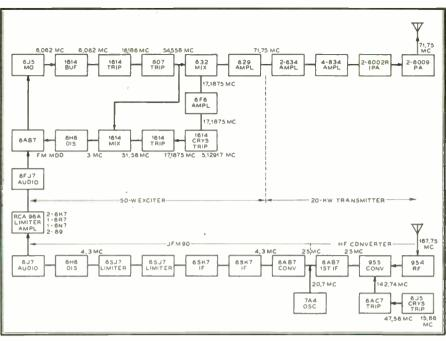
FIG. 34. SOUND RECEIVER WHICH FEEDS THE 20-KW. SOUND TRANSMITTER
