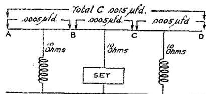
FIG. 1— HOW THE MULTIPLE-TUNED ANTENNA OPERATES
