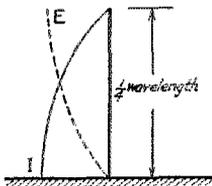
FIG. 1 VERTICAL ANTENNA
