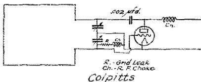
FIG. 2. LOOP SENDING CIRCUITS
