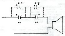
C1 & C2 ... 47 UF ELECTROLYTIC 25VDC C (A & B) .. 10 UF ELECTROLYTIC 25VDC
