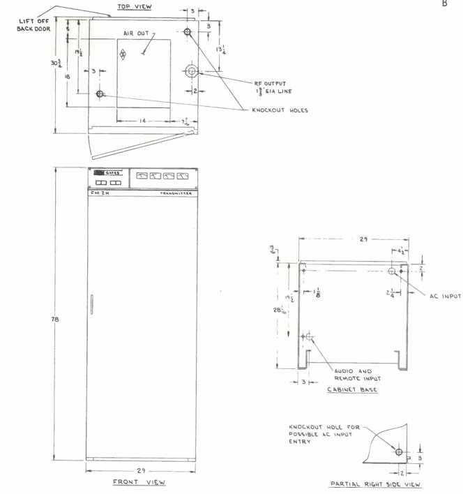
FIGURE 7-3. INSTALLATION LAYOUT FM-2.5K 838 4123 001
