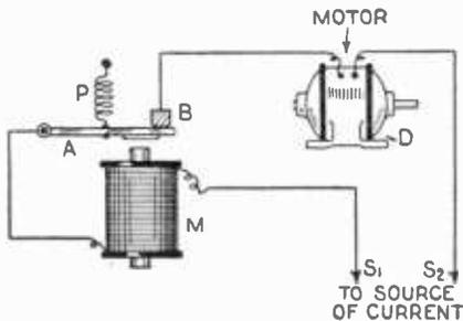
Fig. 1. Overload Circuit Breaker.
