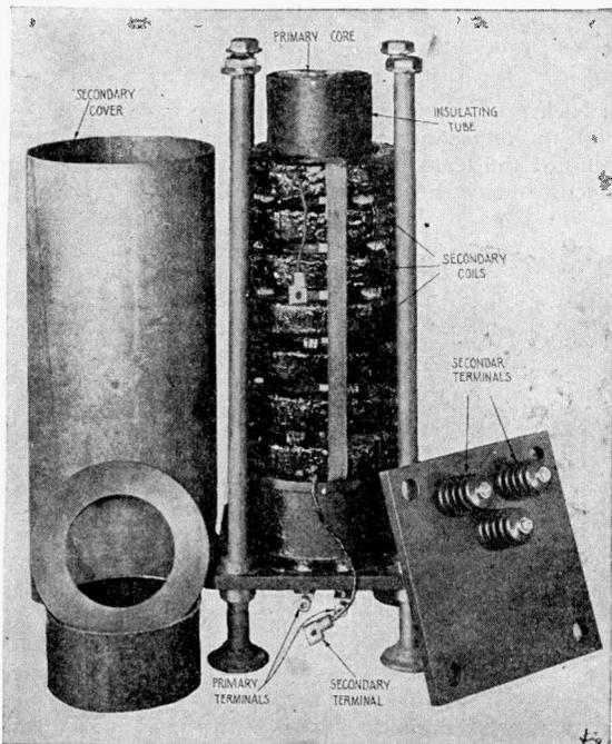
Fig. 131—2 K. W. 500 Cycle Open Core Transformer.
