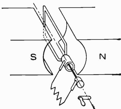
Fig. 24. Simple Dynamo Diagram
