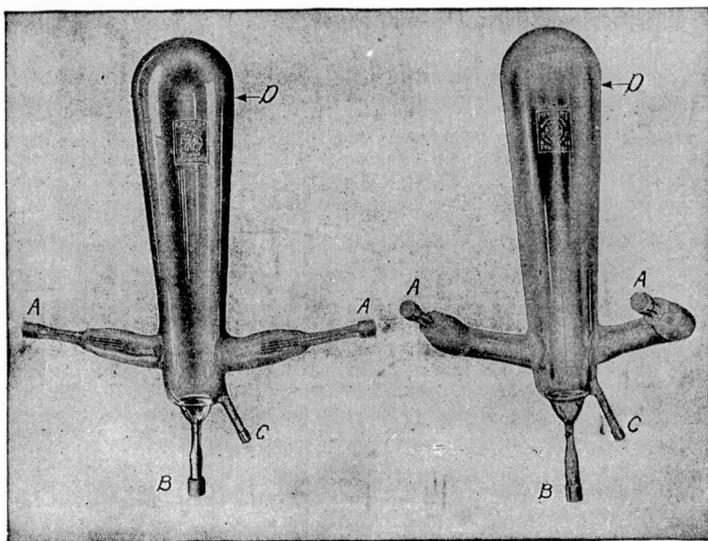
Fig. 284. Mercury-Vapor Arc Rectifiers
