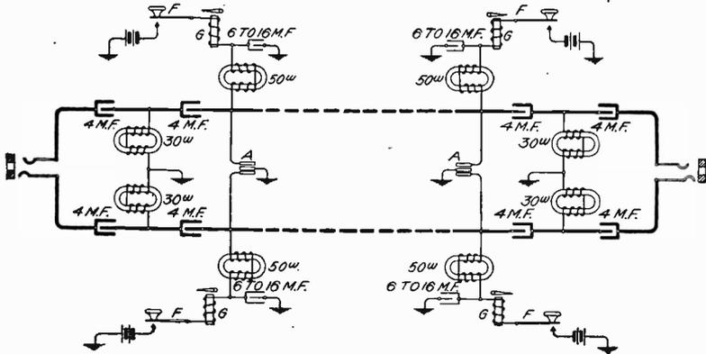
Fig. 233. Composite Circuit
