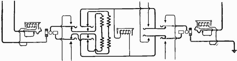
Fig. 128. Convertible Cord Circuit
