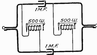
Fig. 135. Double Clearing-Out Drops
