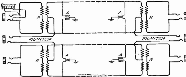
Fig. 225. Phantom Circuit
