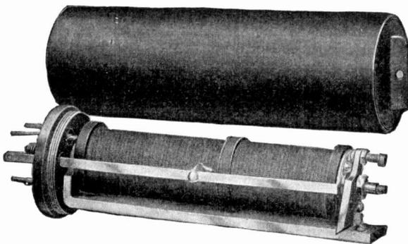
Fig. 217. Trunk Relay
