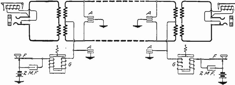
Fig. 230. Simplex Telegraph Circuit
