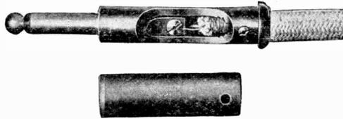
Fig. 112. Switchboard Plug
