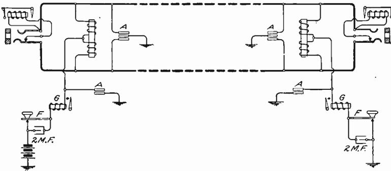
Fig. 231: Simplex Telegraph Circuit
