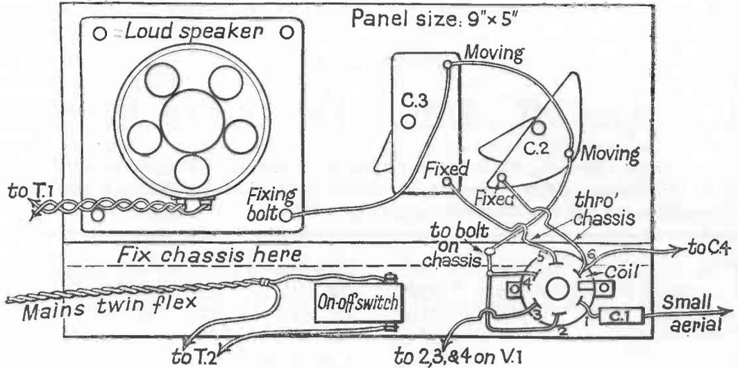
Fig. 20A Wiring Diagram Panel
