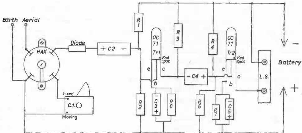
Fig. 30 Wiring Diagram
