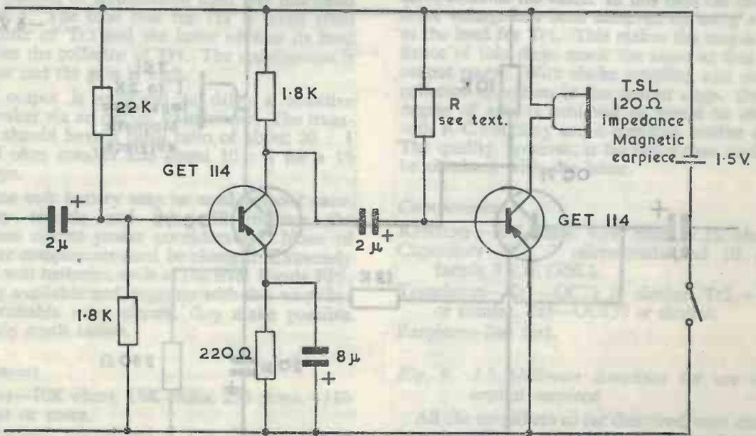
Fig. 4. 5 mW. amplifier.
