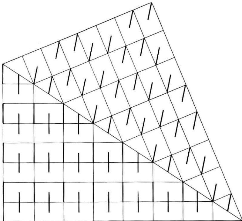
Fig. 17 —  $(200)[\frac{1}{2}\frac{1}{2}0] \cdot [\frac{1}{2}\bar{1}\bar{0}]$ :  $(110)$ :  $(1\bar{1}0)[0\bar{1}0] \cdot [\frac{1}{2}\frac{1}{2}0]$  phase boundary in  $(110)$  twin.
