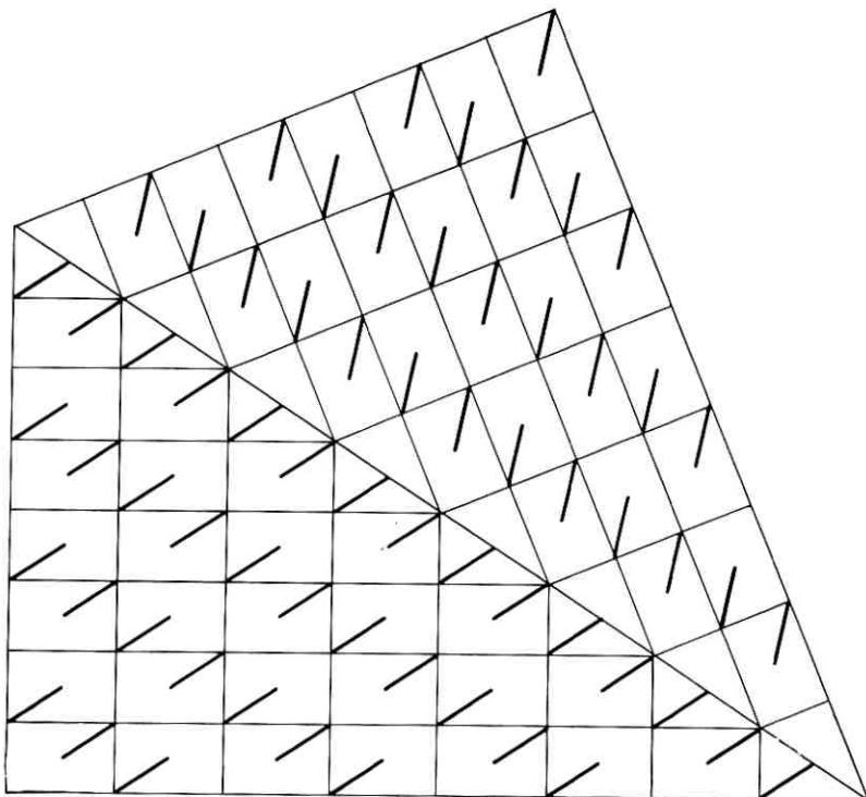
Fig. 16 —  $(1\bar{1}0)[\frac{1}{2}\frac{1}{2}0]:(110):(1\bar{1}0)[\frac{1}{2}\frac{1}{2}0]$  domain boundary in  $(110)$  twin.
