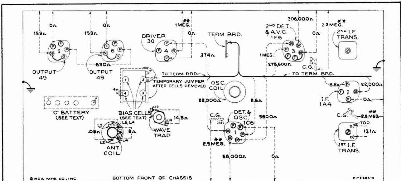
Figure 5—Resistance Diagram
