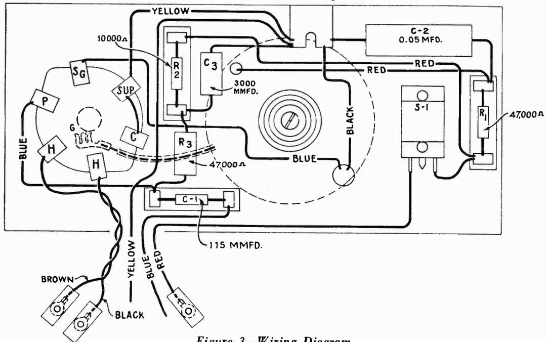
Figure 3—Wiring Diagram
