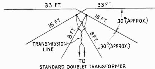
(d) Triple Doublet Antenna for 40, 20 & 10 Meter Bands
