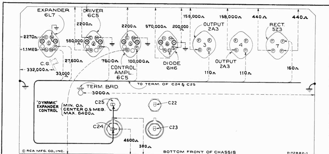
Figure 5—Resistance Diagram
