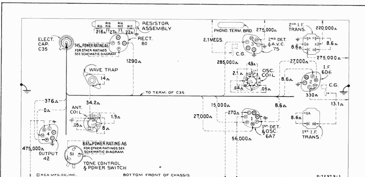
Figure 5—Resistance Diagram
