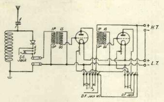
Fig. 5 .- A "double filament" jack
