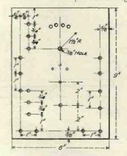
Fig. 5 .- Dimensions of panel.
