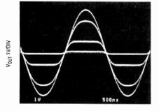
200kHz SINE WAVE WITH V<sub>CONTROL</sub> = -5V, -4V, -3V, -2V
