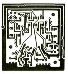
Fig. 8. Fluxgate sensor p.c.b. layout.
