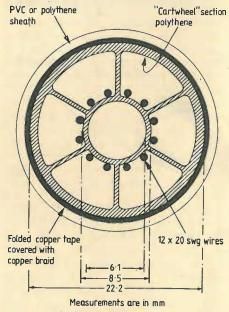
Fig. 6. Dipole-mode cable.
