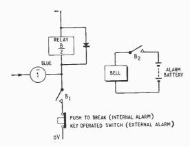
Fig. 5. Alarm circuit.
