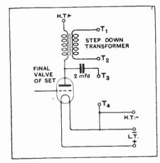
Fig. 1 .- A comprehensive output circuit.
