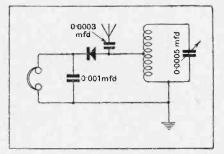
Fig. 2 .- An efficient crystal circuit.
