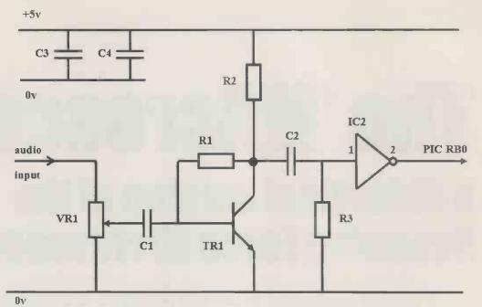
Fig. 18. interface circuit.
