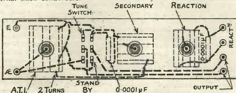
Fig. 6.—Wiring diagram.
