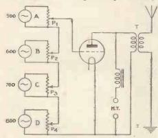
Fig. 1.—Semi-television transmitter
