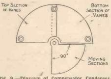
Fig. 9 .- Diagram of Compensator Condenser.
