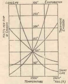
Fig. 1 .- Emission-temperature Graph.
