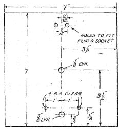
Fig. 2 .- Lay-out of Panel.
