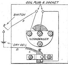
Fig. 4.-Wiring Diagram.
