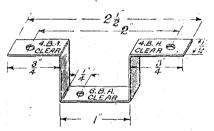
Fig. 3 .- Buzzer Bracket.
