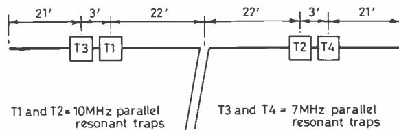
Fig. 8 TRI-BAND TRAPPED DIPOLE FOR 3.5/7/10MHz
