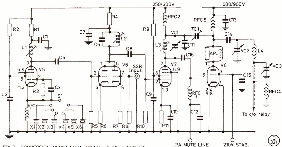
Fig. 2 CONVERSION OSCILLATOR, MIXER, DRIVER AND PA.
