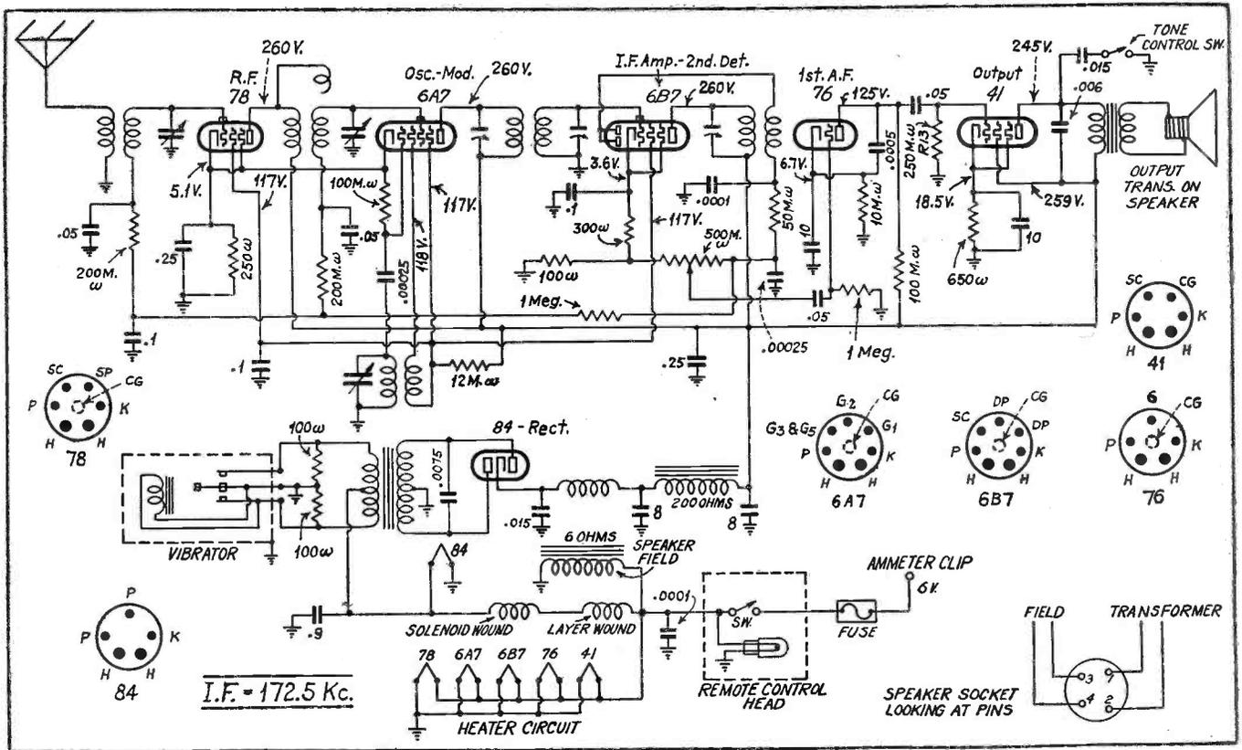
Fig. 1. Emerson E-128 auto-radio circuit.
