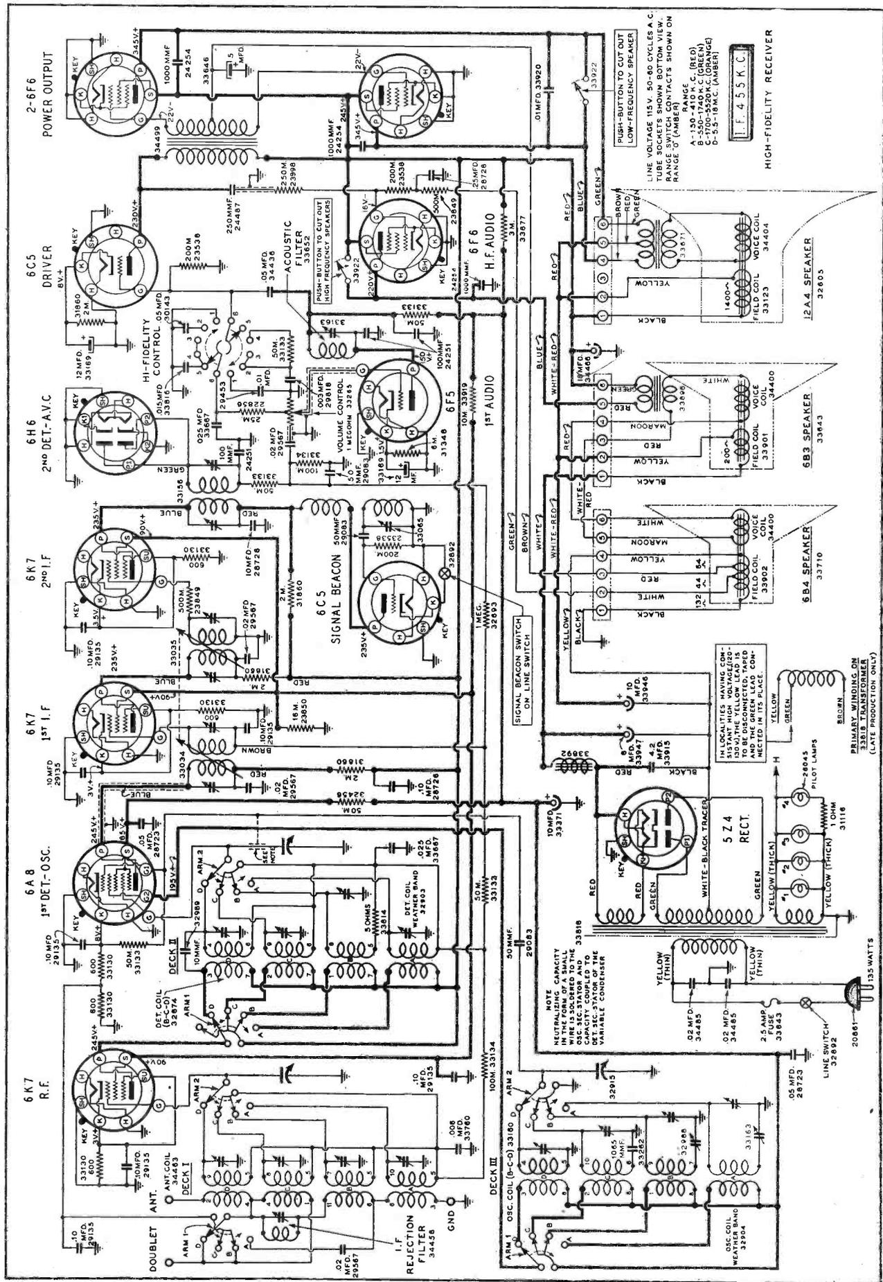
Fig. 1. Grunow 12A circuit diagram.
