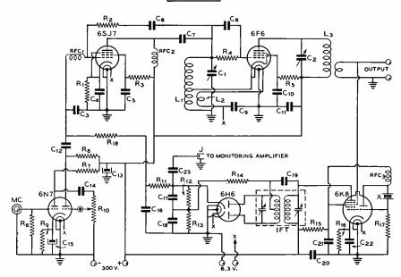
Figure 3. STABILIZED F.M. EXCITER DIAGRAM.
