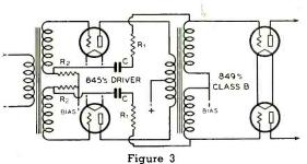
$R_1$ --40,000 ohms  $R_2$ --20,000 ohms C--0.1 µfd. 400 volt
