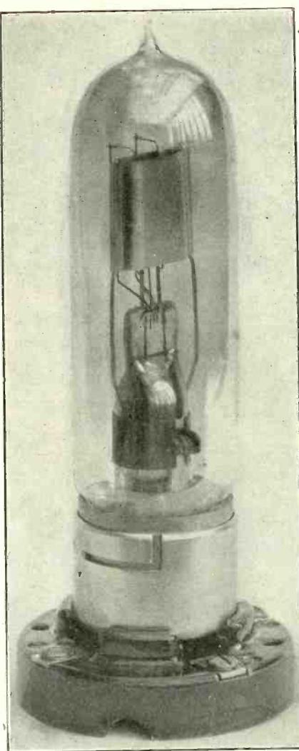
FIG. 2, the UV127 Kenotron (150-watt) rectifier tube. Note the porcelain base socket.
