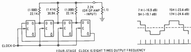
FOUR-STAGE. CLOCK IS EIGHT TIMES OUTPUT FREQUENCY
