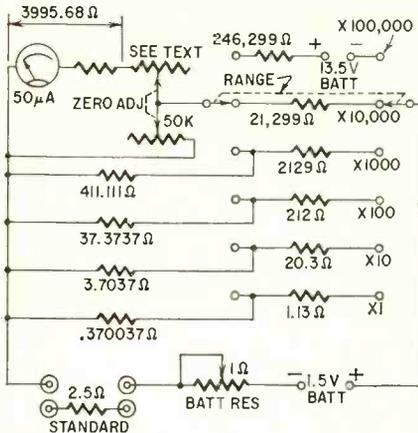
Fig. 4—Complete precision ohmmeter.
