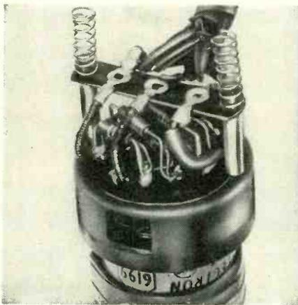
Phototube socket arrangement.
