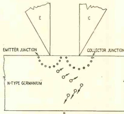
Fig. 2—The point-contact p-n-p type.
