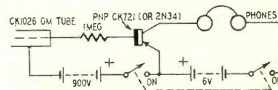
Fig. 4—Grounded-emitter amplifier.
