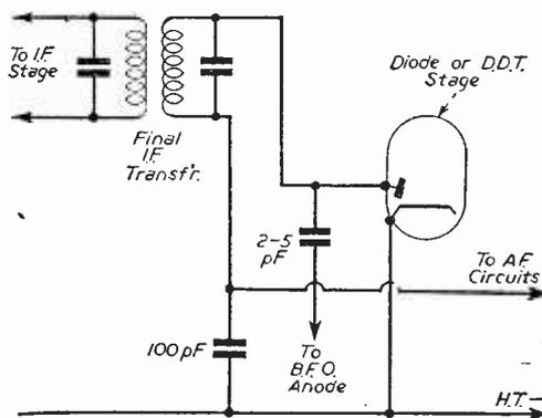
Fig. 3.—A diode input circuit.
