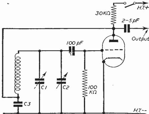
Fig. 2.—A triode oscillator circuit.
