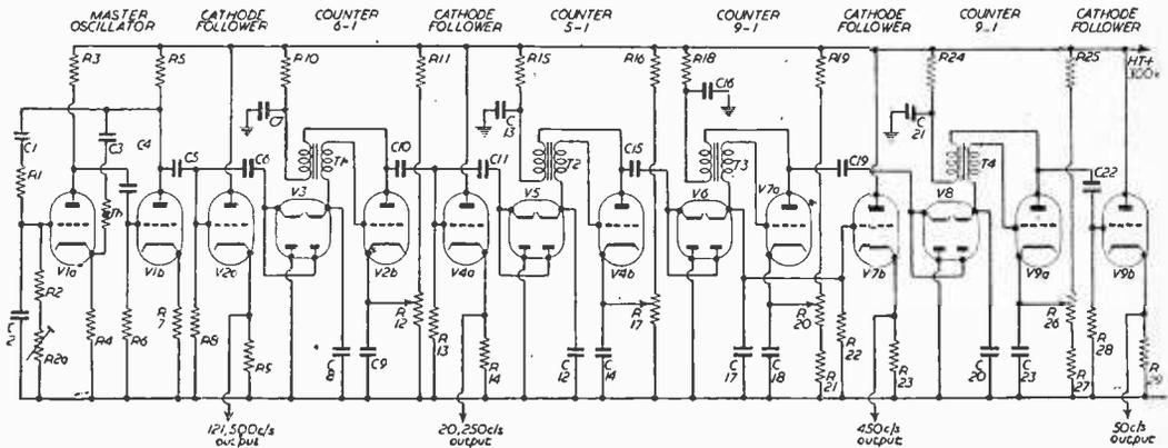
Fig. 2.—Timer unit circuit.
