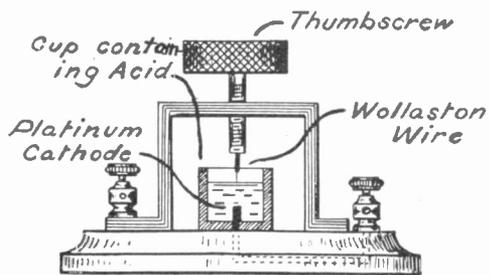
FIG. 113. SIMPLE ELECTROLYTIC DETECTOR
