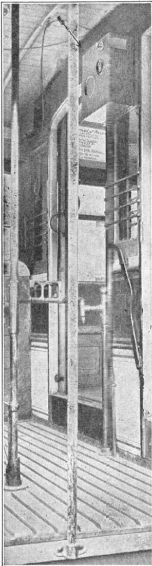
COASTING RECORDER MOUNTED IN THE VESTIBULE OF A CAR
