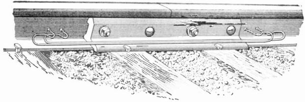
FIG. 10. BONDED RAIL JOINT
