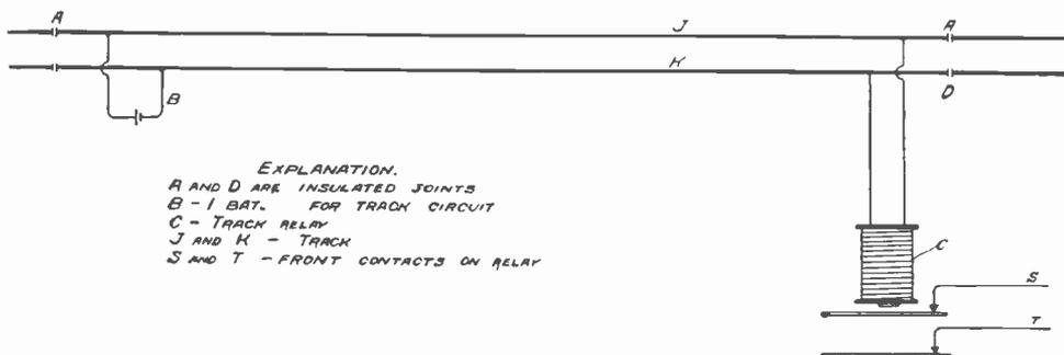
FIG. 6. MOST COMMON FORM OF TRACK CIRCUIT
