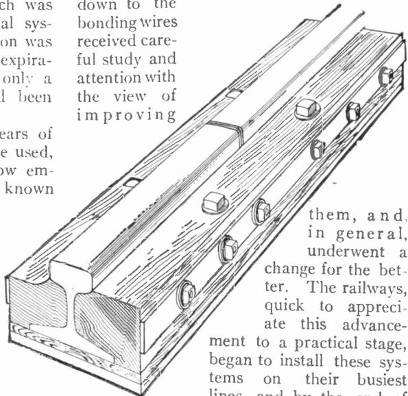
FIG. 8. SHOWING HOW TRACK JOINTS ARE INSULATED
